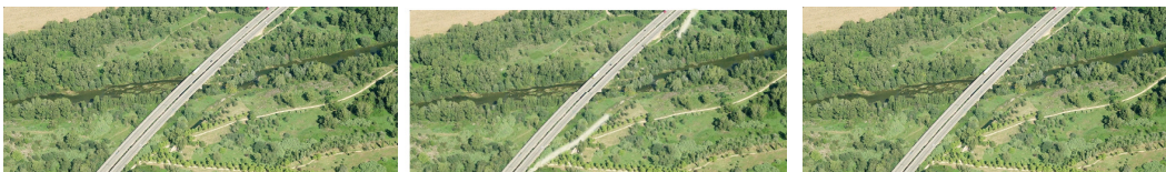
Foto 6 – Fotomuntatge il·lustratiu de l'impacte transitori del soterrament de la línia MAT. Abans, immediatament després de les obres i passat dos anys. Font: Elaboració pròpia.
